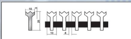
Грязезащитные коврики, сформированные из алюминиевых профилей, скрепленных между собой. Рекомендуются в качестве дополнения к другим типам ковриков в местах, где происходит интенсивное изнашивание чистящих элементов.
