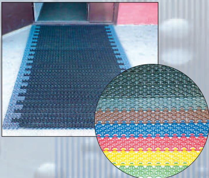
Состоит из отдельных модулей размером 390x52 мм, выпускается высотой: 10, 15 и 20 мм. В квадратном метре 50 модулей. Удобен для того чтобы собирать ковер любой желаемой площади и конфигурации, а также скомбинировать цвета или изобразить на покрытии рисунок.
